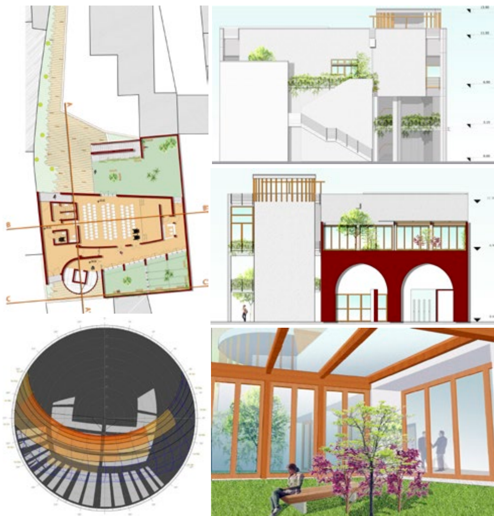
Fig. 5. Rilievi e interventi sulla Casa Tramacère di Veglie. Da sinistra in alto, in senso orario: pianta del piano primo di nuova realizzazione; prospetto Nord; sezione CC; render: vista interna dalla serra bioclimatica; studio bioclimatico della serra: maschera d'ombreggiamento con la sovrapposizione delle analisi della temperatura esterna.
