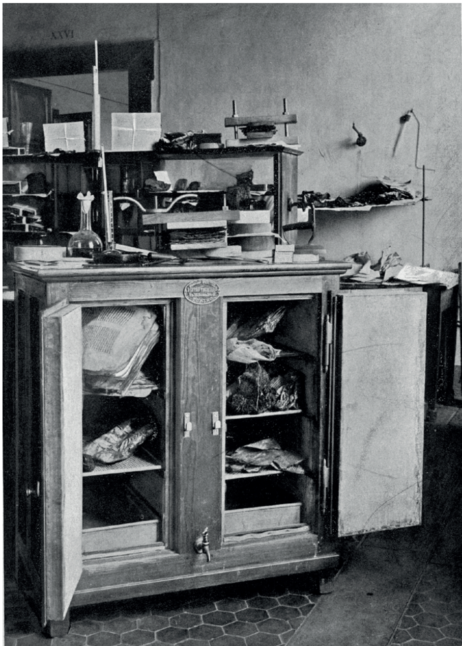
Fig. 14. Camera umida per il distacco dei fogli, MiBACT, Biblioteca nazionale universitaria di Torino®.
