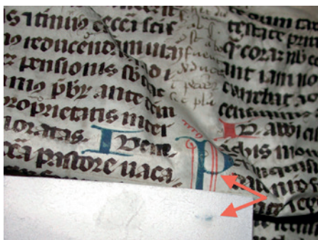
Fig. 5 (sopra). Test di solubilità del pigmento azzurro.
