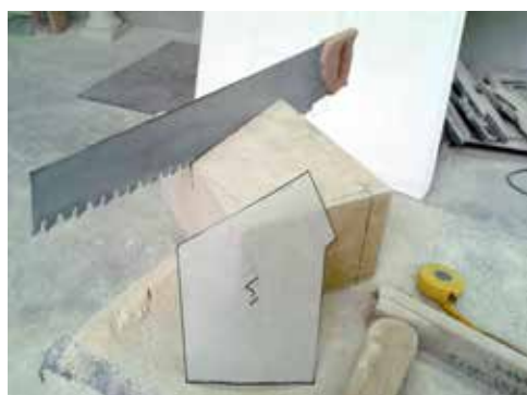
Fig. 13 Paper template for stonecutting (photo Journal d'une formation de taille de pierre , in http://formationtailledepierre.blogspot.com/ , last accessed on 22 May 2019).
