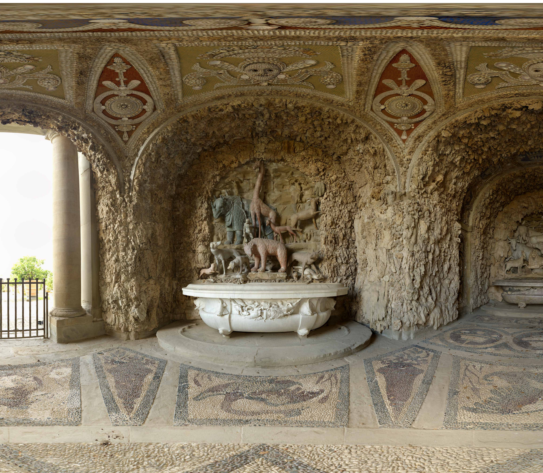
Tav. 22 Immagine panoramica dell'intera grotta degli Animali, composta da 126 fotografie, riprese a 360° sul piano orizzontale e a 180° su quello verticale, quindi il rapporto tra i lati è 2:1. In una proiezione equirettangolare le sole linee rette che rimangono tali sono quelle verticali e l'orizzonte (GECO ottobre 2013).
