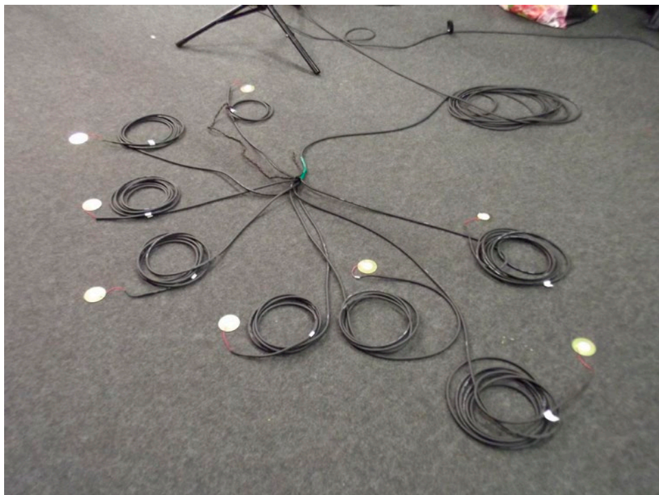
Figura 12. Matrice di trasduttori piezoelettrici per la trasmissione delle informazioni sulla posizione del performer sulla pedana.
