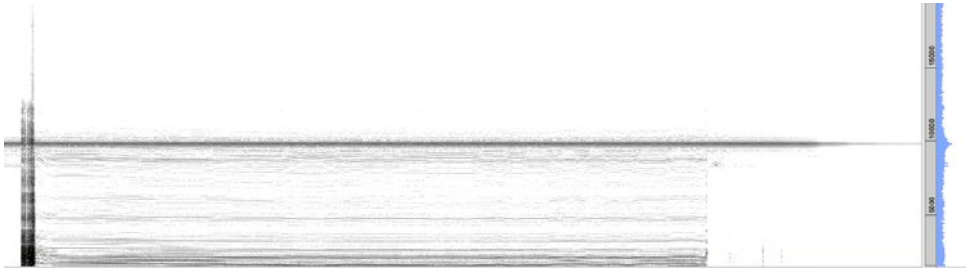
Figura 8. Spettro del suono prodotto dalla punta di plastica del rasoio a vibrazione appoggiato con forte pressione su un tavolo di legno
