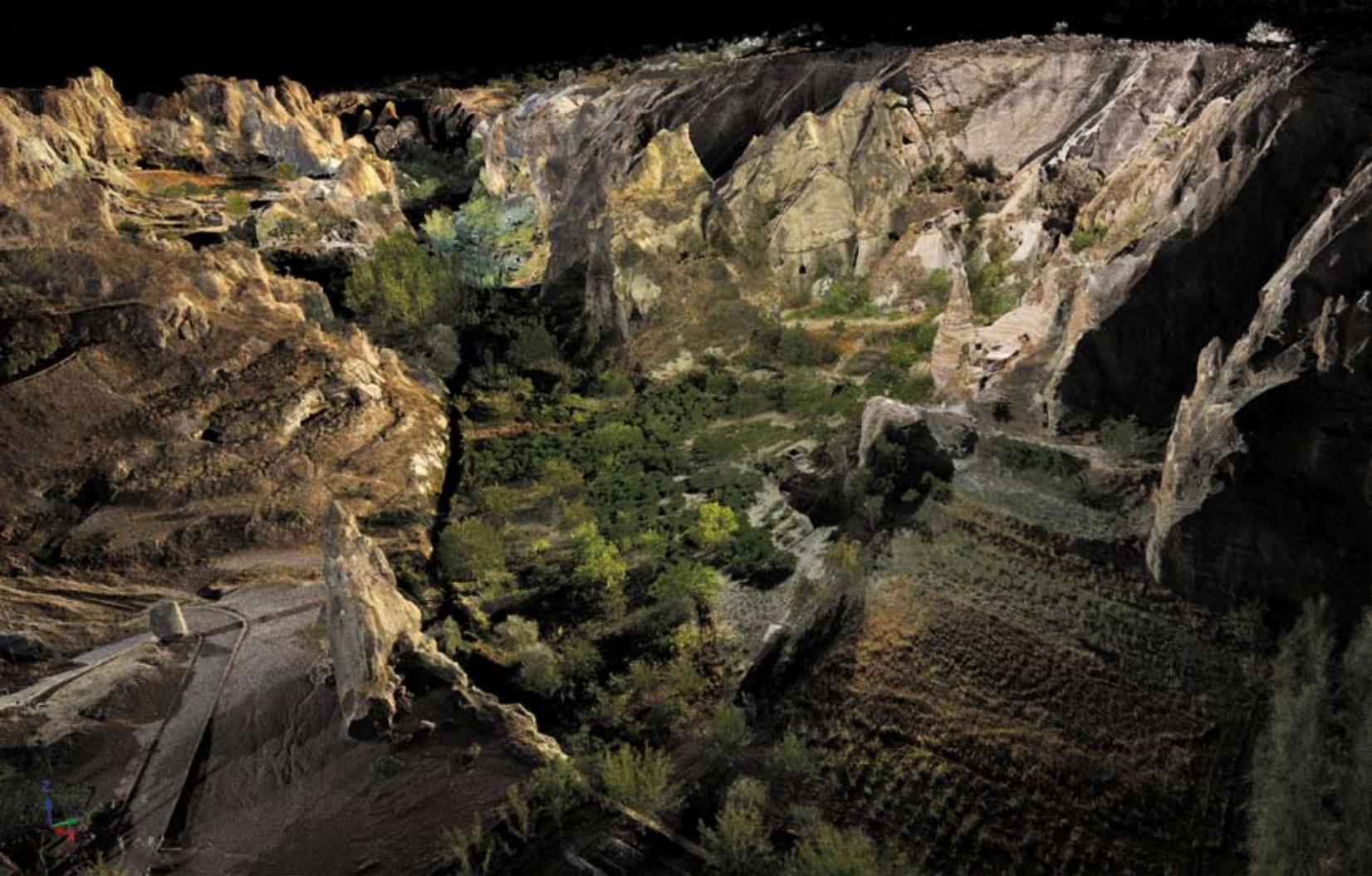
ad una risoluzione più bassa (densità della nuvola mediamente pari a 7 cm ad una distanza di 100 m dal centro dello scanner).
