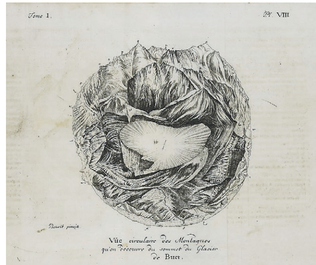
Fig. 4. Vue circulaire des montagnes qu'on découvre du sommet du glacier du Buet ( Voyages dans les Alpes , t. I, Pl. VIII). Bien que Bourrit ait travaillé à l'aide d'un graphomètre, les hauteurs des montagnes situées au-dessus de l'horizon ont été exagérées pour plus de clarté.
