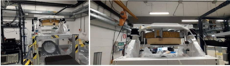
Figura 1. Sinistra: il banco di test di SPLATT, con lo specchio attivo montato sulla torre di misura su un banco ottico. Destra: il prototipo LATT, dettaglio sul supporto in nido d'ape in alluminio e sulla shell sottile (in appoggio sul cuscino di sicurezza in gommapiuma).
