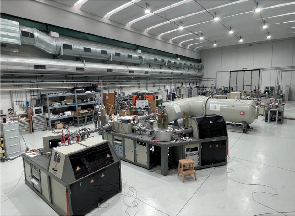
Figura 1. Sala sperimentale (35x15 m<sup>2</sup>) che ospita l'acceleratore tandem del LABEC. In primo piano la sezione a bassa energia con le sorgenti di ioni.
