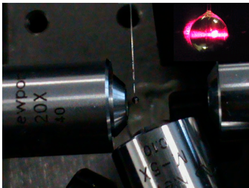
Figura 1. Dettaglio del sistema ottico per l'accoppiamento a una goccia di olio siliconico (diametro 1 mm) sospesa ad una fibra di silice e illuminata da un laser a 640 nm. Insetto in alto: luce diffusa dalla goccia.
