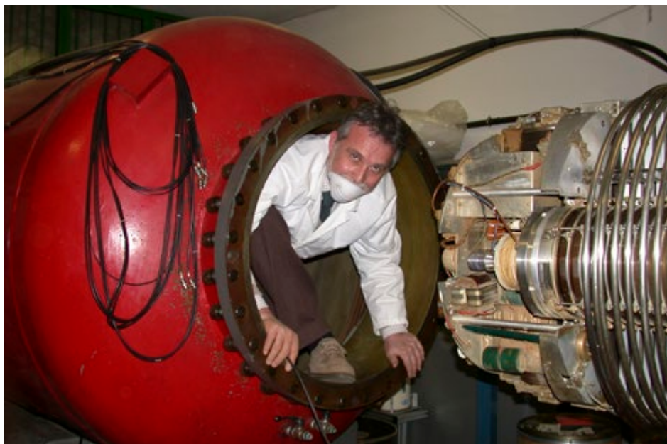
Fig 1. P.A.M. mentre esce dalla tank del KN3000 dopo aver accuratamente pulito le superfici interne dalla polvere dovuta al consumo della cinghia di carica (fra le dita, il filo di alimentazione dell'aspirapolvere, ancora all'interno)
