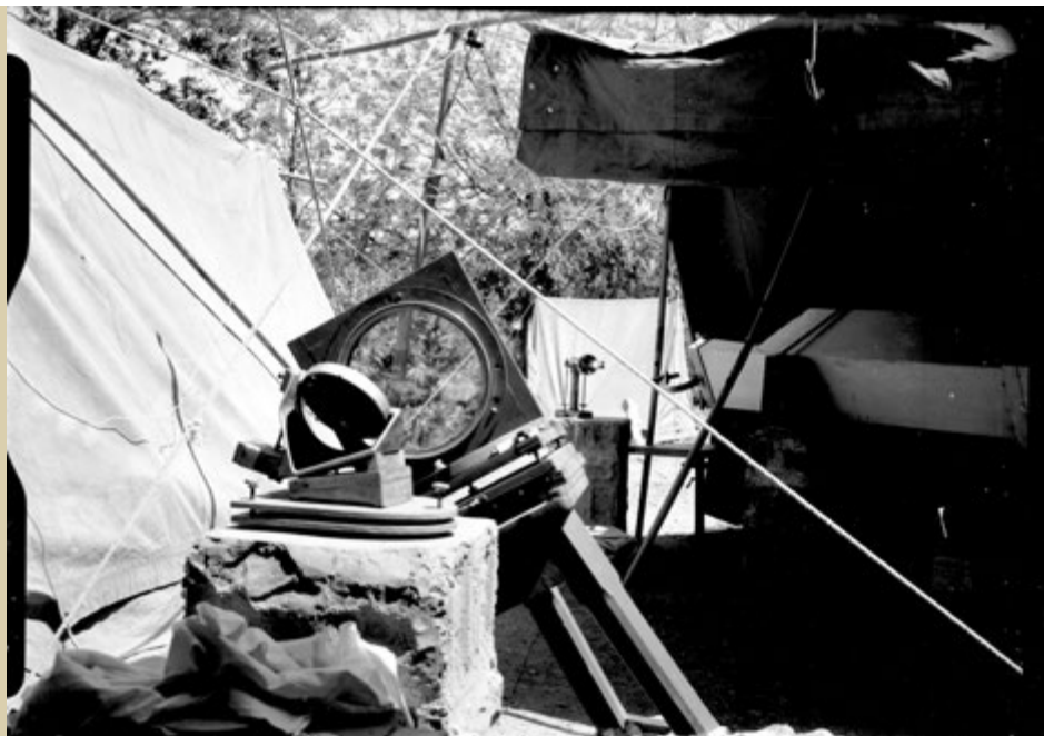
Fig. 2. L'obbiettivo Amici I utilizzato per l'osservazione dell'eclisse totale del 25/2/1952, a Khartoum in Sudan. La luce del Sole, deviata da uno specchio motorizzato (celostata; in primo piano davanti all'obbiettivo) passava attraverso l' Amici I e veniva messa a fuoco sulla fenditura dello spettrografo (il parallelepipedo a destra) dopo un'ulteriore riflessione su un altro specchio (sullo sfondo). (Archivio Fotografico Osservatorio Astrofisico di Arcetri).
