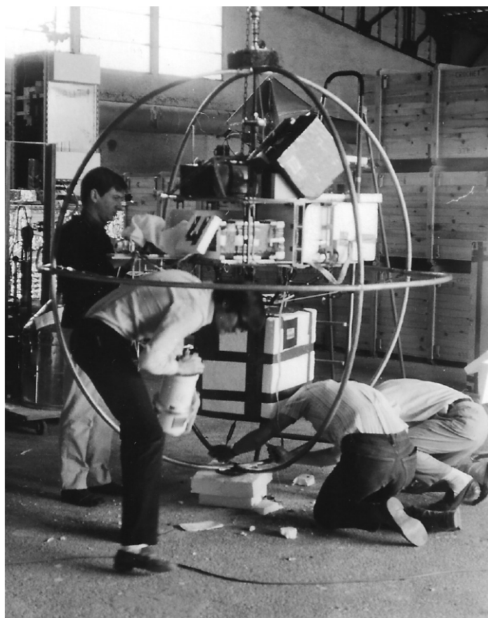
Figura 2. Misura del dipolo del fondo cosmico. Preparazione dello strumento per lancio con pallone stratosferico da Gap, Francia, nel 1970 (Cortesia Francesco Castagnoli).
