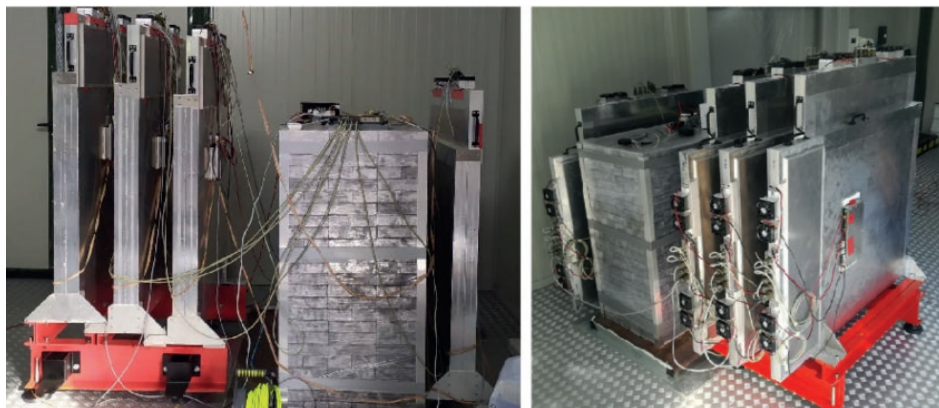
Figura 5 Uno dei tre rivelatori MURAVES installati presso Casina Amelia sulle pendici del Vesuvio. Il rivelatore è costituito da quattro piani traccianti da 1 \text{ m}^2 .
