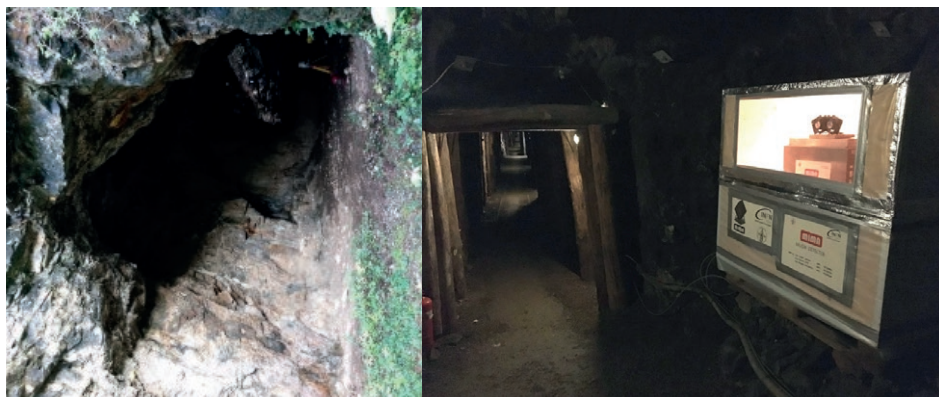
Figura 10. L'ingresso crollato della Gran Cava (a sinistra) e il rivelatore MIMA che acquisisce dati all'interno della miniera del Temperino, nella galleria aperta ai turisti a 50 metri di profondità (a destra). Il box che protegge il rivelatore è dotato di una finestra che consente ai turisti in visita di vedere cosa c'è all'interno. Il rivelatore è rivolto verso l'alto.
