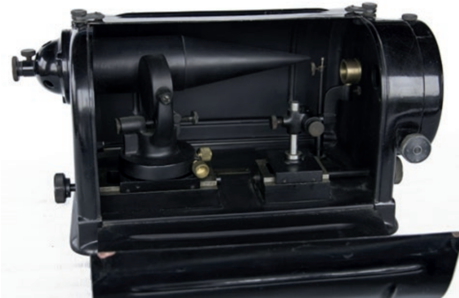
Figura 6. Il risolvimetro interferenziale progettato da Raffaello Bruscaaglioni. Lo strumento è ancora conservato, funzionante, all'Istituto Nazionale di Ottica. Foto P. Mazzinghi. Cortesia INO-CNR.
